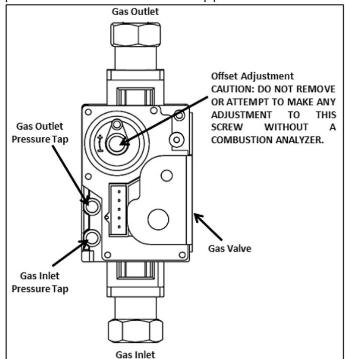
**Figure 48 –Gas Valve Detail**
